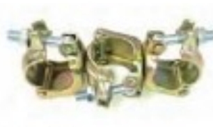
48.6φ用 三連直交クランプ (20入) 単管パイプを3本連結させる時の金具として使用 (直交は片方が自在に動き、片方は90度に)
