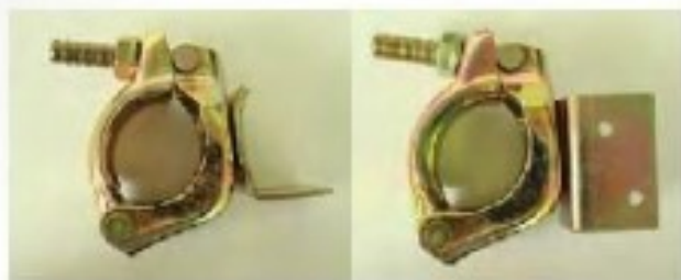
42.7φ・48.6φ兼用 たる木止めクランプ (固定50入・自在50入) 単管パイプを組んで、屋根付きの小屋や倉庫を建てる時に使用 (クランプにはL字型の金具が付いており単木と単管を繋ぐことができる)
