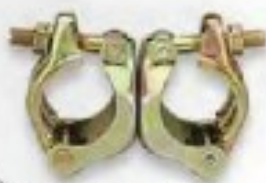
④ 42.7φ・48.6φ兼用 兼用自在クランプ (30入) 単管(支柱)と単管(支柱)をつなぐために使用 (90度以外にいろいろな角度でパイプを接合できる)
