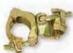
④ 42.7φ・48.6φ兼用 兼用直交クランプ (30入) 単管(支柱)と単管(支柱)をつなぐために使用 (パイプを90度に接合する為のクランプ)
