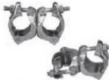
(溶融亜鉛めっき) 48.6φ用 ドブクランプ 直交・自在 単管(支柱)と単管(支柱)をつなぐ ために使用 (受注生産)
