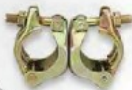
④ 42.7φ・48.6φ兼用 兼用自在クランプ (30入) 単管(支柱)と単管(支柱)をつなぐために使用 (90度以外にいろいろな角度でパイプを接合できる)
