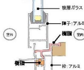
下枠に断熱樹脂を組込んだアルミ製窓。
