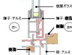
室外側にアルミ、室内側に樹脂を採用した断熱窓。
