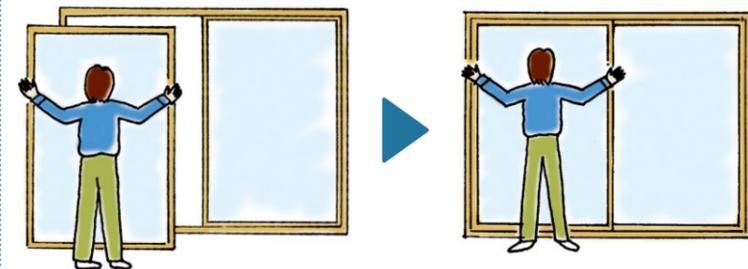
サッシ枠はそのまま、障子(窓の可動する部分)だけを複層ガラス仕様の障子に取替えます。
