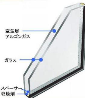
複層ガラスに空気よりも熱伝導率の低いアルゴンガスを注入した仕様で、さらに断熱性能が高まります。〈Low-E複層ガラス〉に適用すると効果的です。
