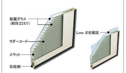
複層ガラスの断熱性能にブラインドの遮熱性能をプラス。
