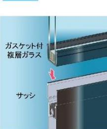
気密性を高める軟質材と、組立負荷を軽減する硬質材を自社で独自に複合・成形した軟・硬質複合ガスケット。あらかじめ複層ガラスに装着してあるのでガスケットを巻く手間が省け、そのままサッシに組込めます。組立て時間を大幅に短縮できるほか、ガスケットの縮みによるすき間ができにくいのも特長です。
