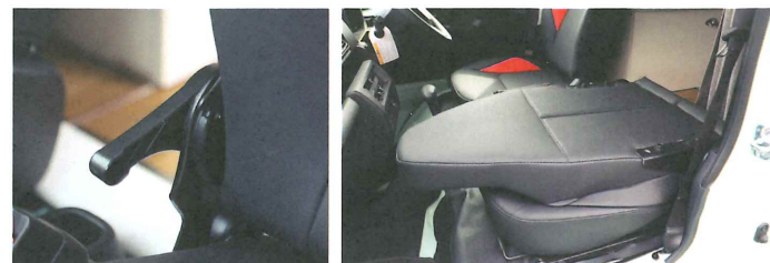
助手席の背もたれを完全に折れるので後方へ行きやすい
