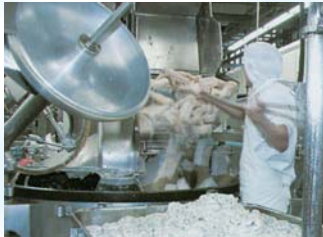
▲リフトボーイによる原料自動投入
