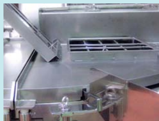
◆ 密閉カバー原料投入口
