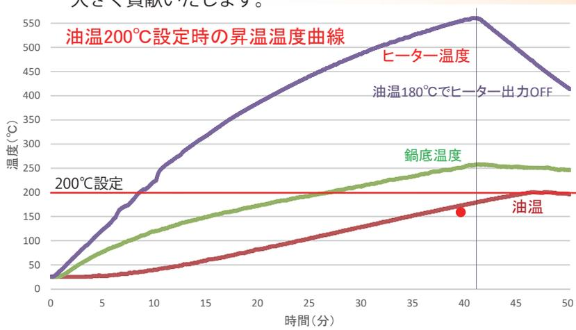
油温 200°C でのヒーター側面温度の測定値は 34°C を表記 (※測定時の室温は 26°C)
