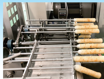
6. 串抜き後、冷却・包装工程へ移載
