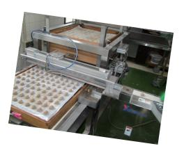
▼整列供給搬送後、ハンドリングロボットによる深絞り包装への自動供給
