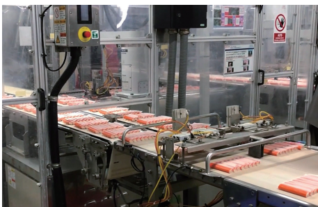
▼整列供給後、ハンドリングロボットによる深絞り包装への供給
