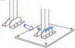
※左右柱共、垂直に立っているか、水平規にて確認してください。垂直でない場合は、柱の根元にワッシャーなどを挟んで、レベル調整してください。
