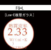
※平成25年省エネルギー基準 建具とガラスの組合せによる開口部の熱貫流率( Low-E複層ガラス(空気層10mm以上))
