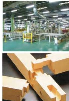
骨組み加工はプレカットを採用し、高度なクオリティーをもつ住宅を、より短時間で供給できるよう努力しております。プレカットにより加工の均一化が可能となり、精度において 0.1mm の正確さまでコントロールできます。また、様々な資材、部材にも対応でき、お客様の多様なニーズにもお答えできます。木材の大半を工場生産にシフトチェンジしている為、今までのように職人による品質誤差を解消し、均一なレベルの住宅を提供します。
