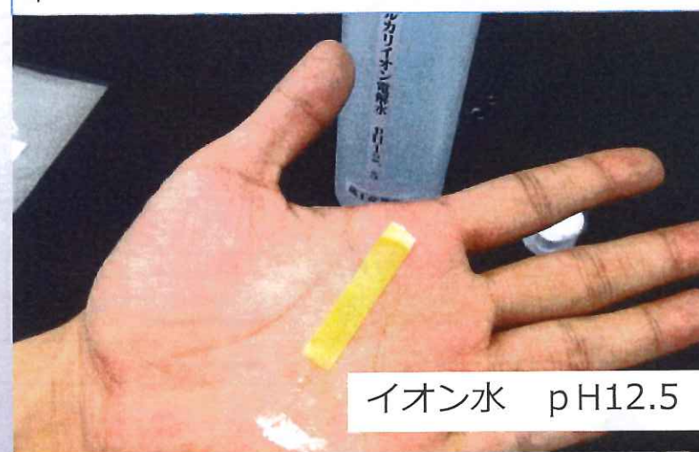
すりこんで乾いた手のひらに少量の水道水を少量垂らし、pHを計測するとアルカリは全く残留していない。
