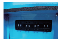
メッセージはデジタルスイッチにて切り替え。充電器付きなので、100Vで強制充電可能。
