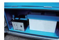
メッセージはデジタルスイッチにて切り替え。充電器付きなので、100Vで強制充電可能。
