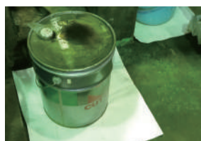
潤滑油等のオイル置き場の油受け
