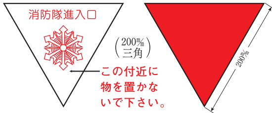
消防隊進入口.A (屋内より貼付)
