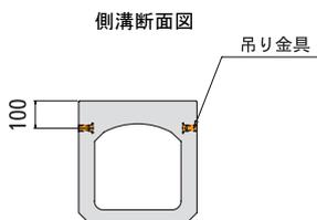
※電柱廻りの側溝寸法は、電柱よけ寸法の指示により自在に調整可能です。
