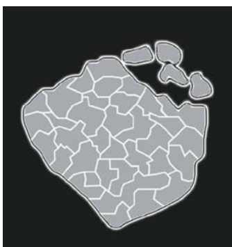
■ 多結晶ダイヤモンド砥粒 自生作用イメージ図
