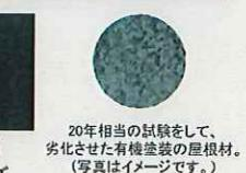
20年相当の試験をして、劣化させた有機塗装の屋根材。
