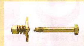
ナットとタイトニックの Wパワー TZ12 引張り強度試験品 (4.3トンでボルト破断、ナットに損傷なし)
