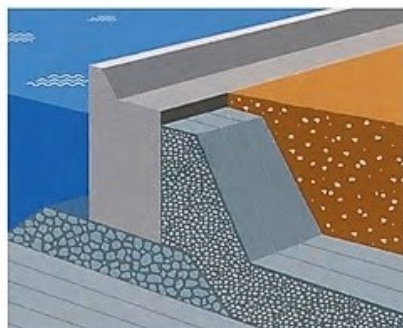
■護岸吸い出し防止
