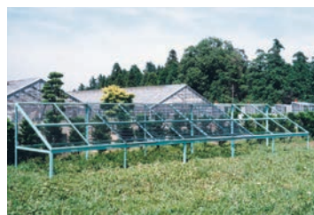
屋外暴露試験状況
