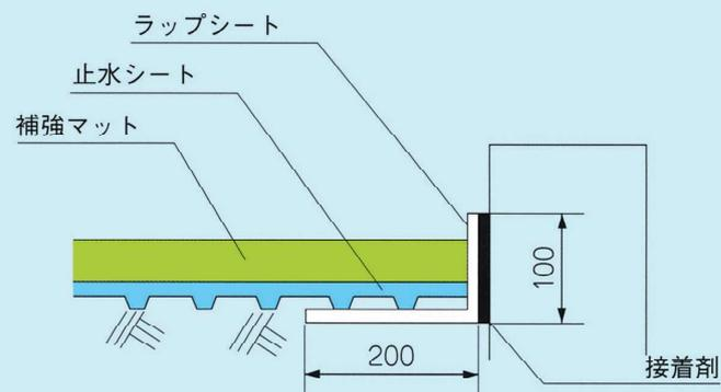
接続用ラップシートを使い基礎及び帯コンクリートに10cm以上接着します。また、接続用ラップシートと遮水マットは20cm以上重ね合わせます。
