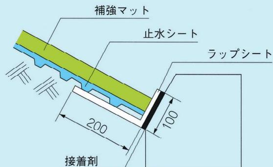
接続用ラップシートを使い基礎及び帯コンクリートに10cm以上接着します。また、接続用ラップシートと遮水マットは20cm以上重ね合わせます。
