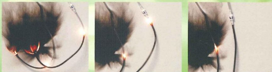
左:ファイアセイフを取り付けていないチューブ 右:ファイアセイフを取り付けたチューブ
