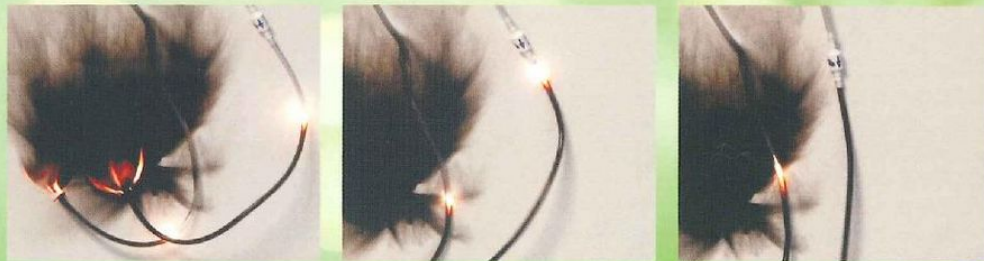
左: ファイアセイフを取り付けていないチューブ 右: ファイアセイフを取り付けたチューブ
