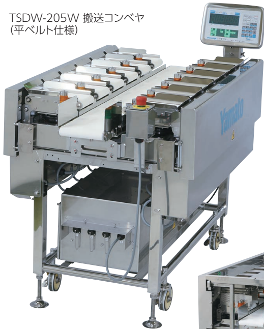
シャッターゲート付 TSDW-205W-SG(オプション) 搬送コンベヤ(平ベルト仕様)
