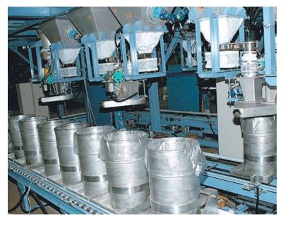
コストパフォーマンスの高いトラバーサ 方式と、高能力対応の計量コンベヤ方 式があります。ペレット、粒等流れ易い 原料は電磁フィーダ、ブリッジ/フラッシュ 性微粉体原料はディスクフィーダで対 応します。
