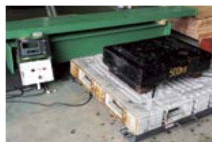
分銅を載せて計量器の精度を確認します。
