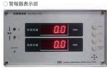
○ デジタル表示と同時に警報を出力する雨量計
