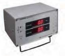
○ デジタル表示と同時に警報を出力する雨量計
