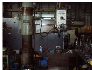
ラジアルボール盤 1450 X 1000 X 1000まで加工可能
