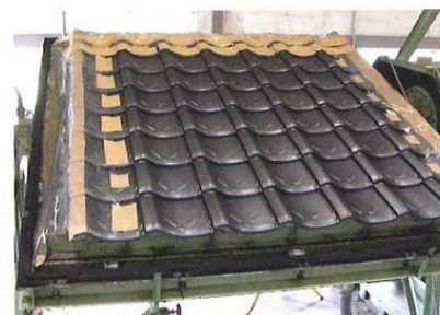
防水性能試験(愛知県三河産業試験場)
