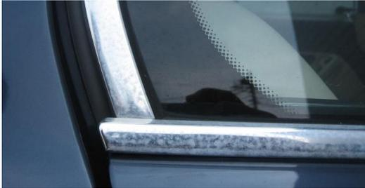
欧州車に用いられているアルミニウム+アルマイト加工のトリムモールの腐食を除去し、腐食防止のコーティングを施します。近年の日本車では、ステンレス鏡面仕上げ素材を用いている車種が増えています。(レクサス等)
