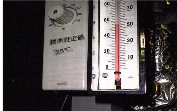
源泉の温度を検知する温度計のセンサー銅線部の表面へ**ブロックキーパー**を施工。数年以上経過後も状態良好。無塗布状態では数カ月で腐食し、断線等発生する。
