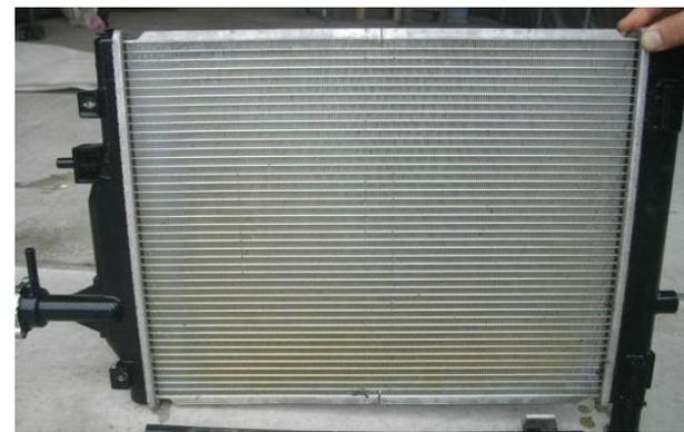
ラジエーター部分を**ブロックキーパー**施工後、草津温泉源泉湯に浸け1か月経過後、腐食等見受けられず、良好
