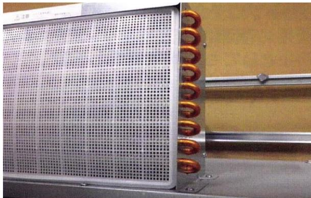
業務用冷蔵庫の熱交機器の銅管部分の表面へ**ブロックキーパー**施工。数年経過後も状態良好。無塗布状態では、半年程度で剥き出しになった銅管が腐食、黒く変色し穴が開いてしまう
