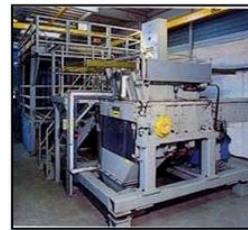
廃プラ⇒固形燃料 11.4t/日(8時間稼働)
