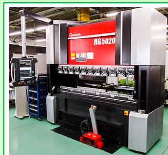
ACサーボモータープレスブレーキ HG5020
