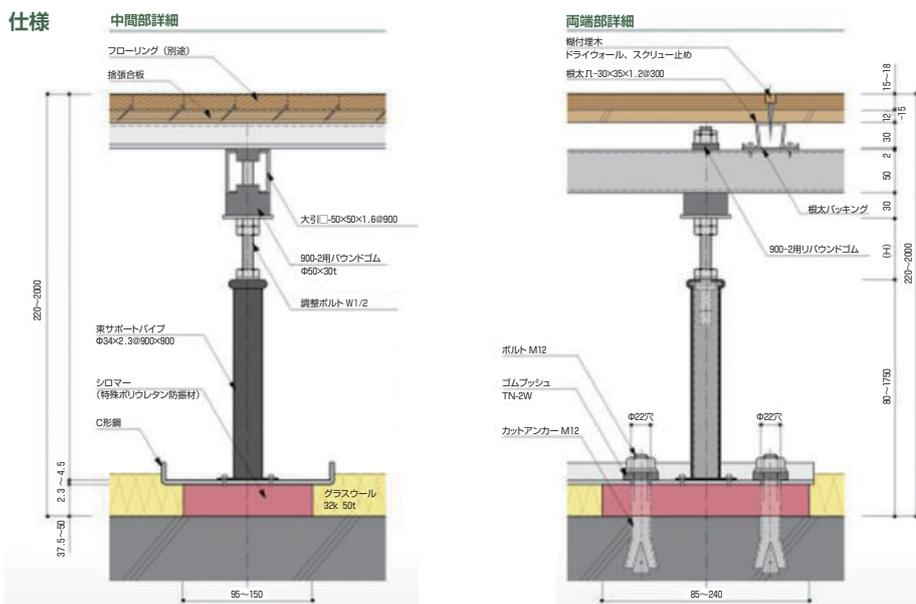
注※シロマー防振材が25mm以下の場合、大引きが上向きとなります。
