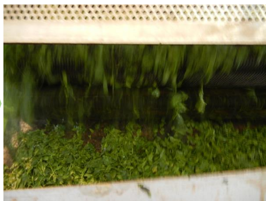
蒸した直後の茶葉 (蒸されて出てきた茶葉は水分を含み柔らかい状態になっています。)
