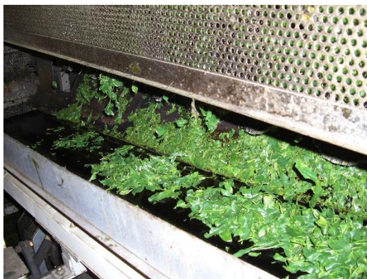
蒸した直後の茶葉 (蒸されて出てきた茶葉は水分を含み柔らかい状態になっています。)
