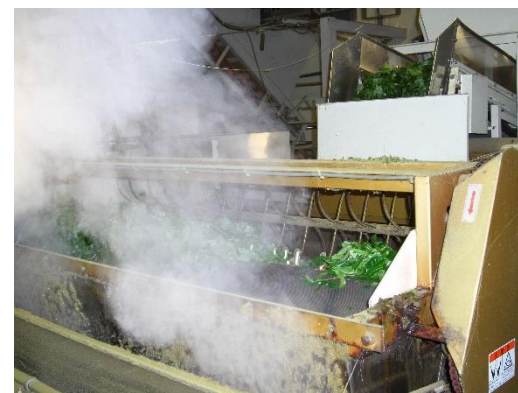
蒸し機 (100℃超の水蒸気でお茶を蒸します。ここがお茶の製造で一番の肝です。)
