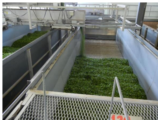
蒸し機へ投入 (有機栽培茶の原料は約60秒～90秒蒸す、深蒸しタイプ)
