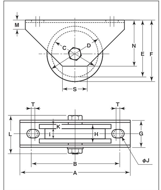
※枠、ボルトの材質はSUS304、車の材質はSUS303です。
