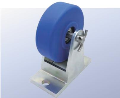
車輪と枠の別注品製作を致しました。枠はSUS304、軸はSUS303、車はMCナイロンを使用。お客様の要望で抜けにくくするために割りピン仕様となっております。
