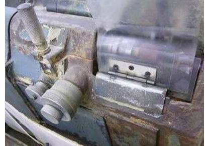
テーブル面に製品を並べて回転させ、ダイヤモンド砥石を当てて研削加工します。ワークスペースが広いので、大きなガラスや多くの小サイズのガラスを精度よく加工する事が出来ます。
