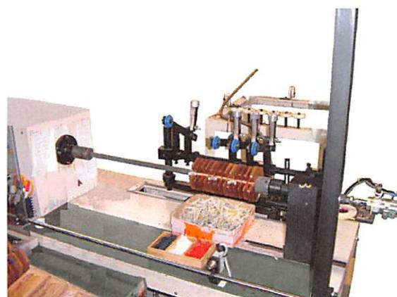
木枠、塩ビの巻枠にて巻線する機械です。安価な巻枠を製作するだけで直ぐに巻線が可能ですので大量な生産から試作用の小ロットまで幅広く対応ができます。機構的には新しい装置はついておりませんが今まで定期的に御注文頂ける巻線機です。
