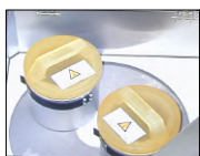
バレル槽可動部
