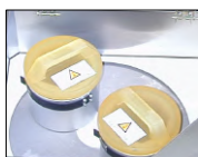
バレル槽可動部
