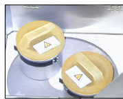
バレル槽可動部
