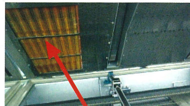
特別仕様の水冷管および冷却フィンユニット Water plumbing and cooling fins unit.
