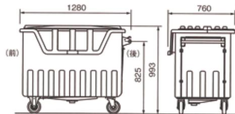
寸法：幅約 1,280 × 奥行約 760 × 高さ約 993 (mm)
