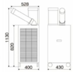
型式：N407-R 寸法：幅約400×奥行約430×高さ約820（mm）
