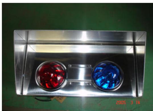
扉の開閉が一目でわかる信号装置を付ける事により庫内からの扉への衝突を防止します
