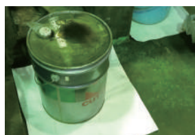
潤滑油等のオイル置き場の油受け
